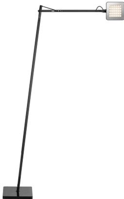
Apparecchio di illuminazione da Terra. Testa in alluminio pressofuso, diffusore in PC. Alimentatore su spina, copertura base in PC stampato ad iniezione, contrappeso in ferro tranciato e verniciato attraverso processo di cataforesi. Testa orientabile. Interruttore ON/OFF con tecnologia Soft Touch a tre step. Base separata dal corpo lampada con grano di sicurezza.
