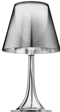
Apparecchio di illuminazione da tavolo a luce diffusa. Corpo in PMMA (polimetilmetacrilato) completamente trasparente stampato ad iniezione ; diffusore interno in PC (policarbonato) opalino stampato ad iniezione e diffusore esterno in PC(policarbonato) trasparente o colorato stampato ad iniezione alluminato – sulla superficie intera – con processo di alluminatura sottovuoto all'interno.
