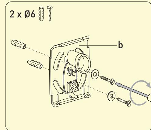
Fissare con i tasselli e le viti la piastra di fissaggio (b) (i fori asolati consentono il posizionamento in bolla e in squadra).
