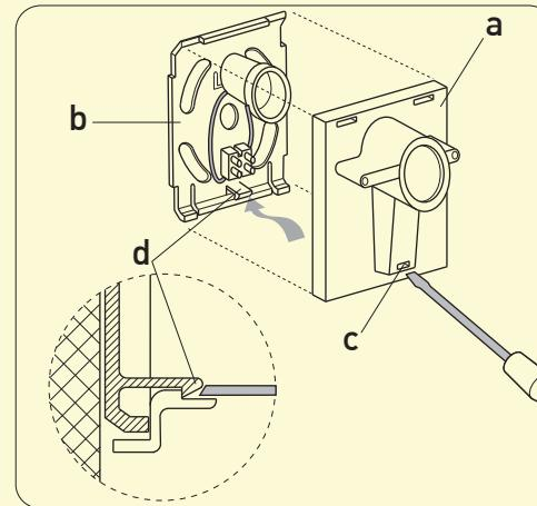
Separare il supporto (a) dalla piastra di fissaggio (b) premendo con una punta nella fessura (c) fino a far scattare la molletta (d).
