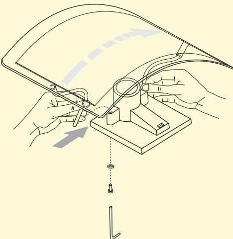
Quando il braccio metallico si trova all'altezza del supporto avvicinarlo allo stesso come indicato dalla freccia ed inserirlo nella cavetta esagonale piegando il diffusore sfruttando l'elasticità del materiale. Per evitare rottura del diffusore limitare la piega al minimo necessario. Fissare i bracci al supporto con le viti a brugola e la chive in dotazione.
