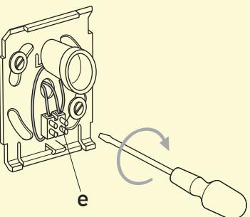
Connettere i cavi di linea nel morsetto (e) rispettando le polarità indicate.
