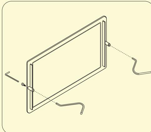
Inserire i bracci metallici nei cilindretti predisposti sul diffusore e fissarli con le viti a brugola e la chiave in dotazione.
