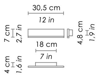
Collezione di lampade a sospensione e parete con corpo in pressofusione di alluminio verniciato bianco opaco, diffusore in policarbonato satinato e fonte luminosa a LED monoemissione.
